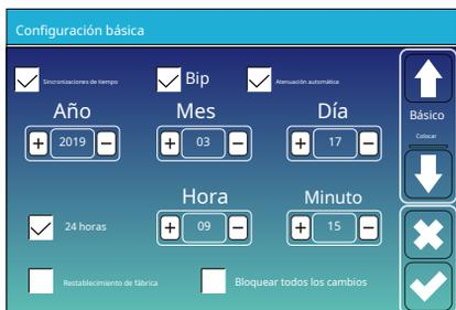
**Restablecimiento de fábrica:** Restablecer todos los parámetros del inversor. **Bloquear todos los cambios:** Habilite este menú para configurar parámetros que requieren bloqueo y que no se pueden configurar. Antes de realizar un restablecimiento de fábrica y bloquear los sistemas, para conservar todos los cambios, debe introducir una contraseña para habilitar la configuración.
